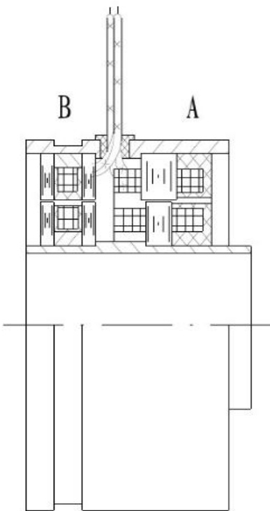
图 1、环形变压器式旋变结构示意图
